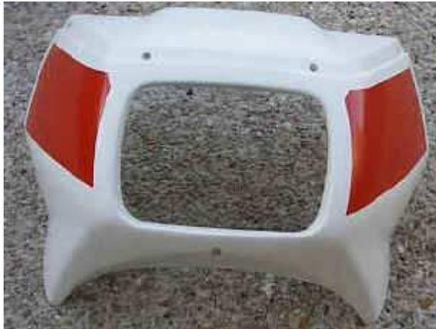
Appliquer plusieurs couche après séchage complet de la couche précédente avec, si nécessaire, un léger ponçage à l'eau de la couche précédente. Une fois la pièce bien sèche, enlever le masquage, positionner le nouveau masquage pour l'autre motif et de nouveau ponçage léger à l'eau de la partie à peindre.
