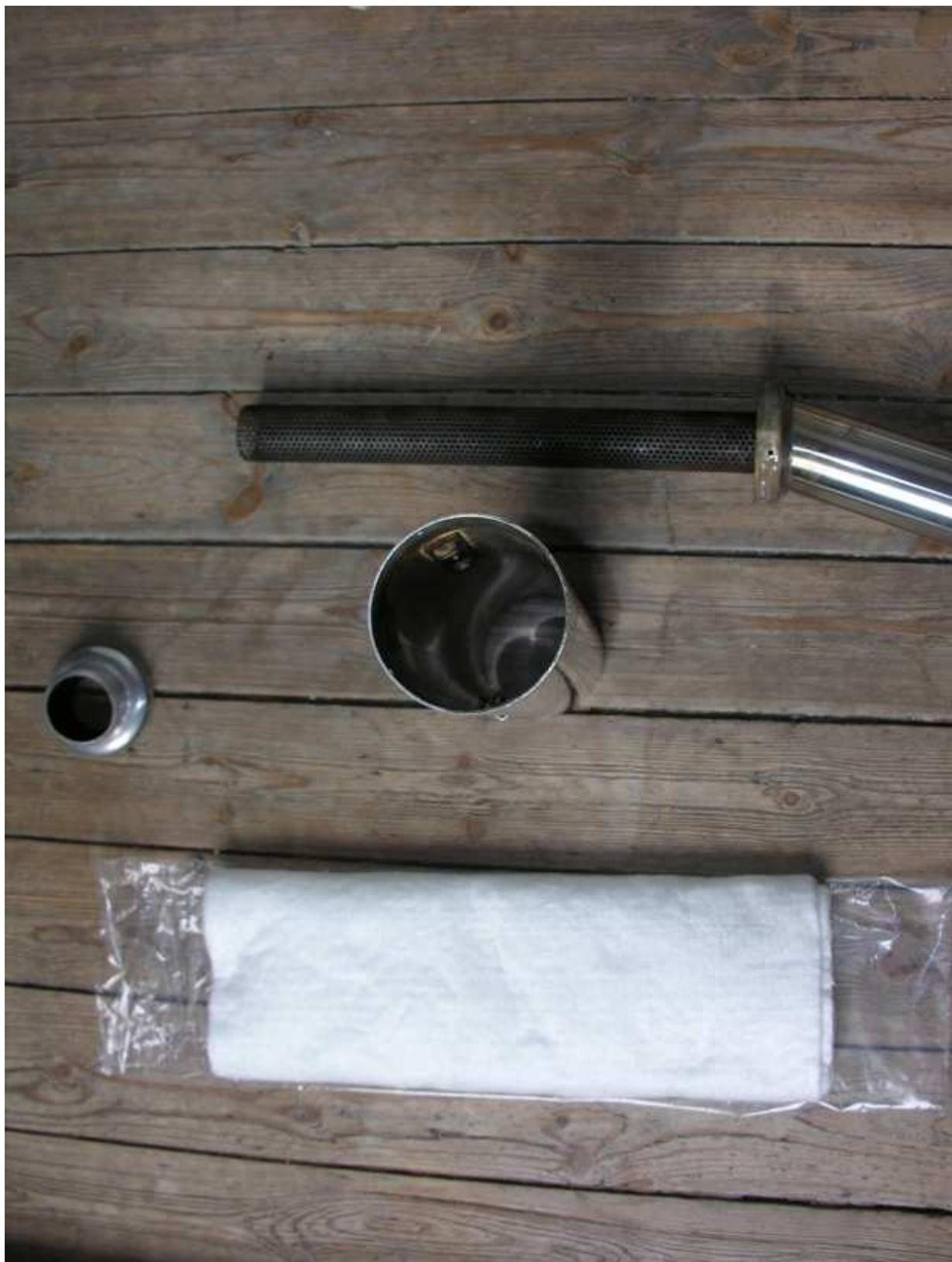
Après on prend l'isolant que l'on peut trouver chez n'importe quel accessoiriste moto et pour pas cher (moi j'ai payé le mien 9€) et on entoure le tube intérieur de l'isolant en prenant soin de bien serrer !
