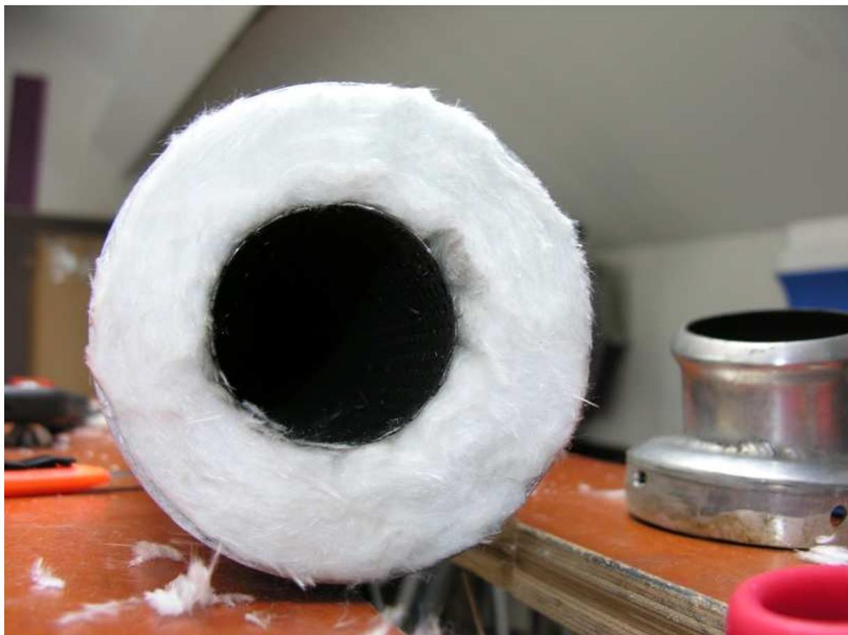
Maintenant prendre soin de retirer tout excédant d'isolant avec un cutteur et remettre le cabochon de sortie d'échappement.
